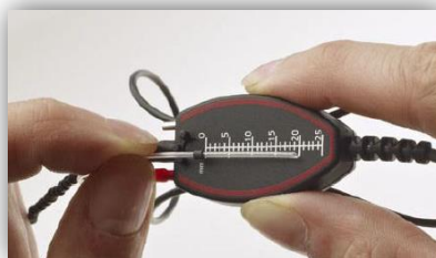
Fig. 8: Het op de juiste lengte plaatsen van de markeerring
