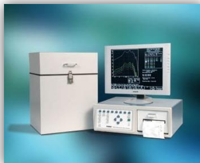
Fig. 1: voorbeeld van een oude 2 CC meetbox, met een meeteenheid, scherm en plotter.
